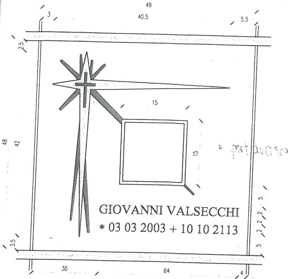
Le lettere dovranno essere realizzate in acciaio inox con altezza massima di mm 20.00, il carattere in uso sarà Times New Romans
